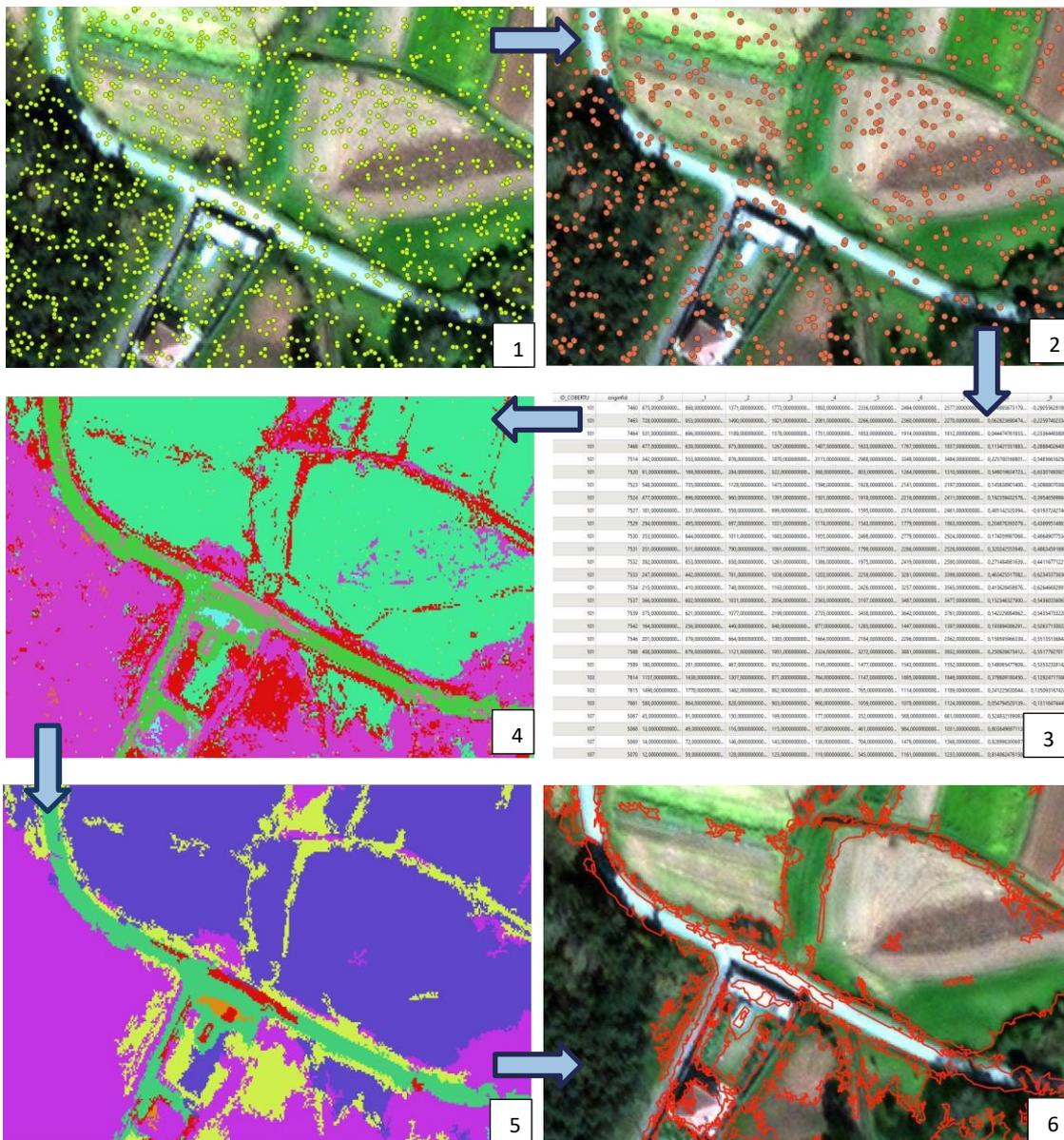
**Imagen 3.** Resultados de algunos de los diferentes procesos de la clasificación por píxel RF. (1) Random points; (2) sample selection; (3) sample straction; (4) image classifier; (5) filtrado; (6) poligonización.
