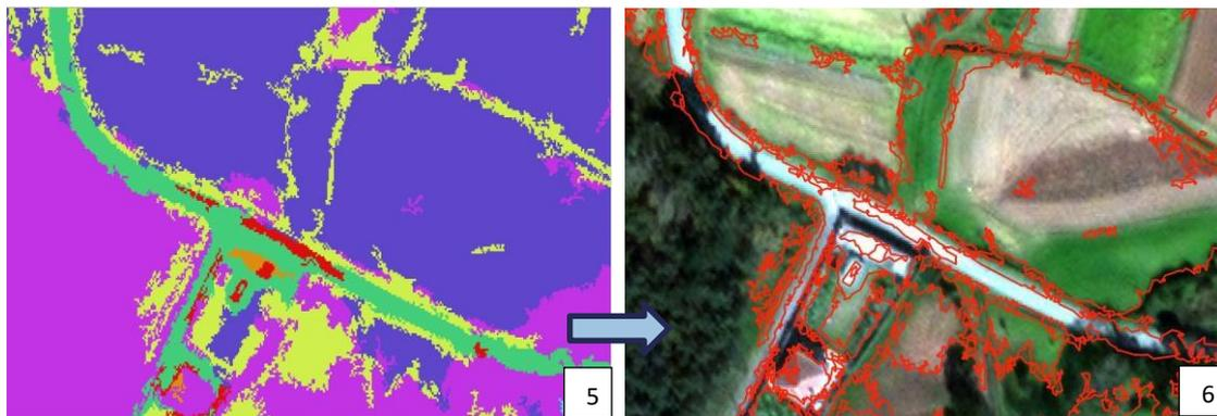
**Imagen 3.** Resultados de algunos de los diferentes procesos de la clasificación por píxel RF. (1) Random points; (2) sample selection; (3) sample straction; (4) image classifier; (5) filtrado; (6) poligonización.
