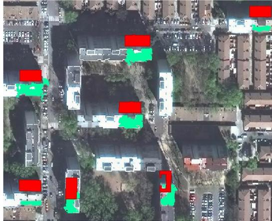
Figura 9. En verde, cubiertas en bruto detectadas sobre imagen WV, en rojo edificios respectivos a la detección de la capa provista por el Ayuntamiento.
