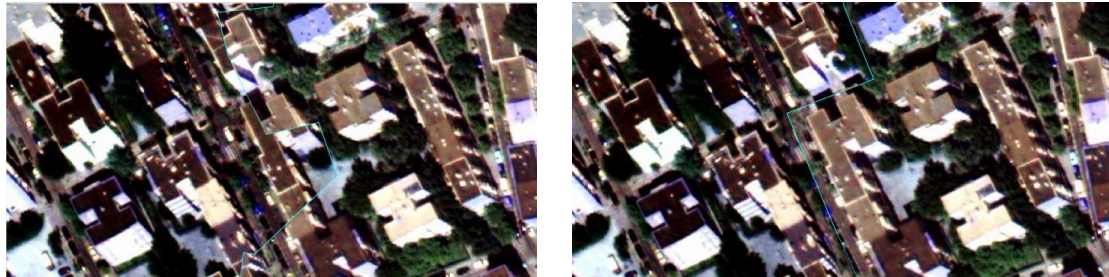
Figura 7. Izq. Línea de corte obtenida, donde se aprecia que, debido a la diferencia de la inclinación en las tomas, los edificios aparecen desplazados. Dcha. Imagen corregida, donde se establece como frontera la carretera para poder corregirla.
